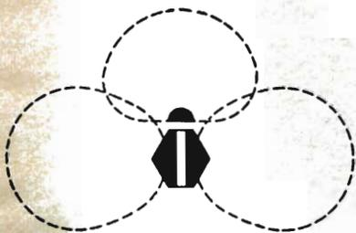
Fig. 6 - Sistema di microfoni stereofonici formato da un microfono con caratteristica a otto e microfono con sensibilità unidirezionale da impiegare nelle registrazioni professionali.
