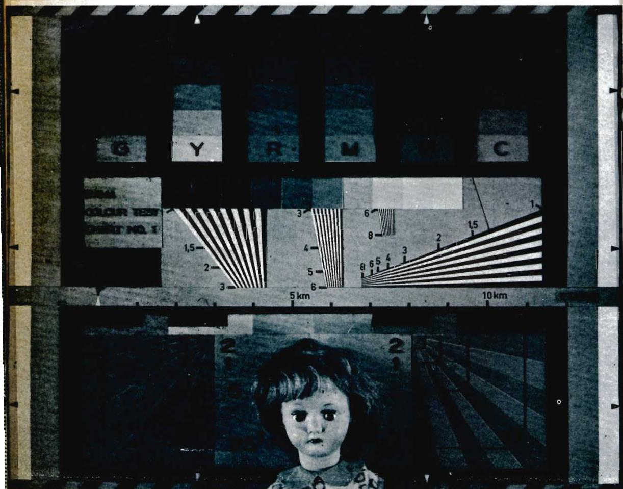
Fig. 1 - Immagine di prova impiegata per controllare i circuiti essenziali di un ricevitore TVC.
